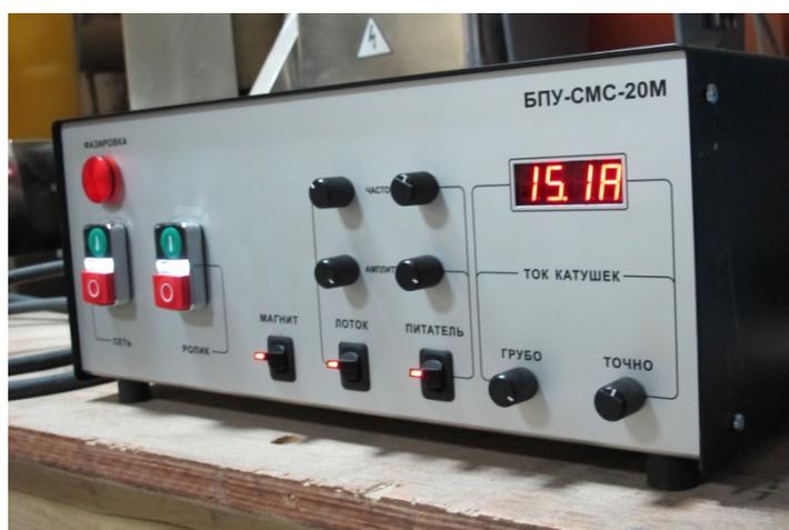
Блок управления сепаратором СМС-20М
