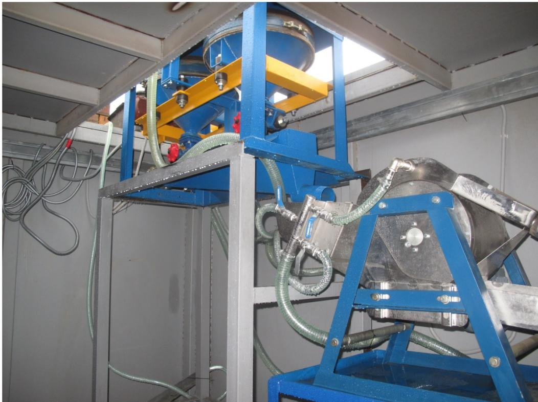
Мокрый магнитный сепаратор MMC-2ГМ в доводочном модуле ДМ-2
