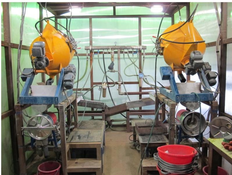
Высоконапорные бутары в геологоразведочном обогатительном модуле (ГРОМ.)
