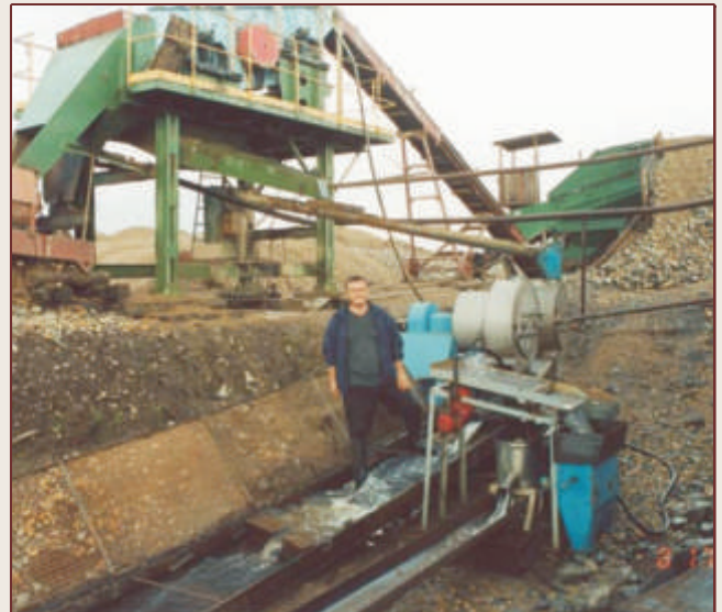
Primera instalación industrial de piloto para la recuperación de oro fino en el distrito de Amursky
