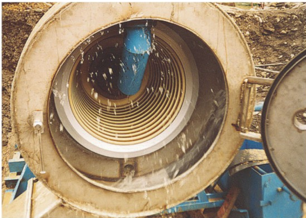
Центробежный концентратор «ИТОМАК-КГ-20» во время работы, 1999 г.
